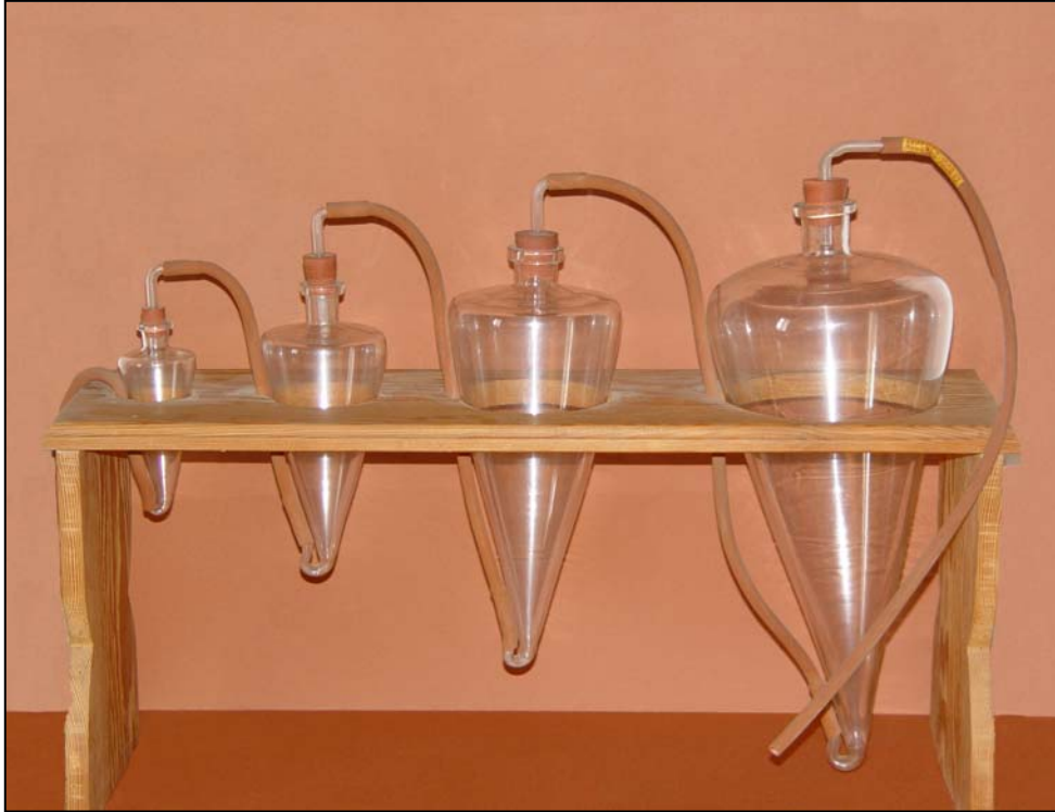
Levigatore di Wolff. È utilizzato per la separazione delle particelle di un campione di suolo in funzione della granulometria. (Museo di Chimica Agraria di Portici)
