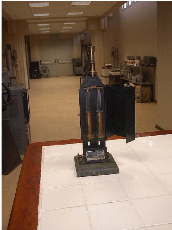
Colorimetro di Duboscq per l'analisi di soluzioni colorate. Anteriore al 1880, inventario: 290. Dal Museo di Chimica di Palermo.
