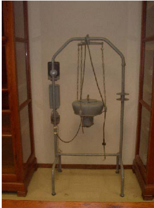
Ultracentrifuga elettrica a sospensione a cavalletti su 4 gambe (n. Inv. 3924, gennaio 1941). Dal Museo di Chimica di Palermo.
